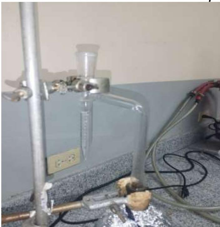
**Proceso para obtención de aceite esencial de eucalipto por hidrodestilación**
