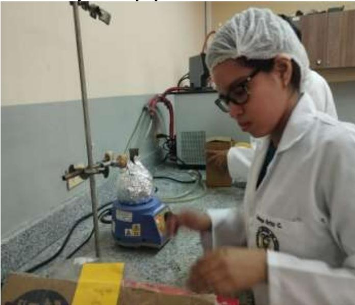
**Proceso para obtención de aceite esencial de eucalipto por hidrodestilación
